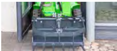
Šírka s pneumatikami 5.70-12 je 930 mm
